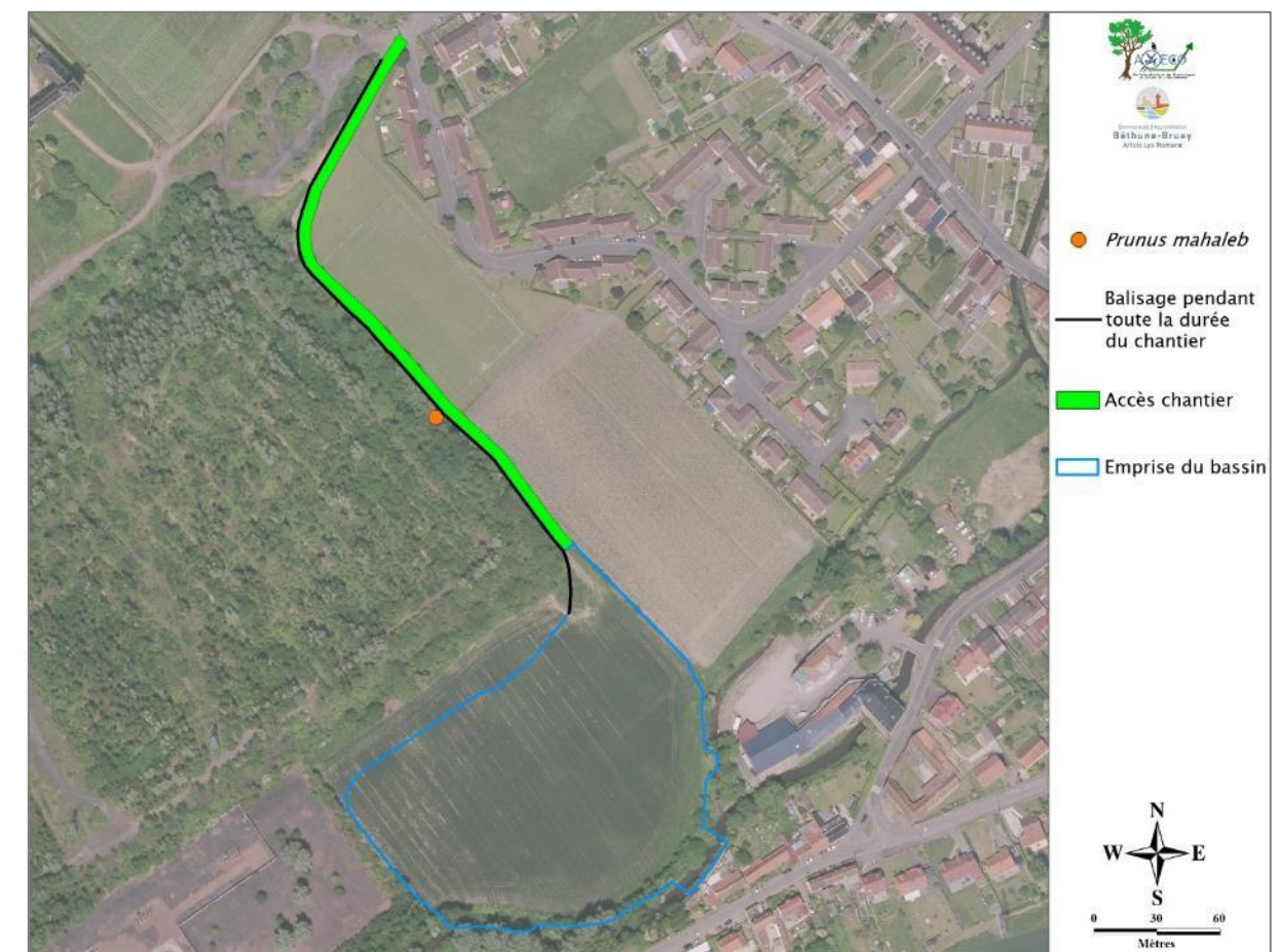
Figure 1 : Localisation de l’espèce végétale protégée par rapport à l’accès chantier, au bassin de la ZEC et au balisage qui sera mis en place pour éviter l’impact sur la station
